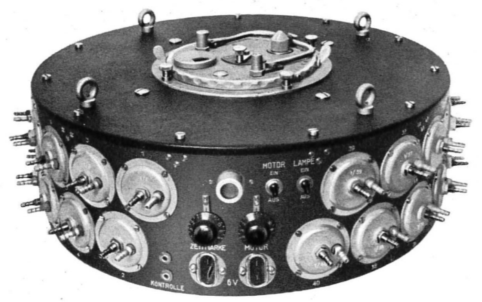
Multiple recording manometer of the Deutsche Versuchsanstalt für Luftfahrt
